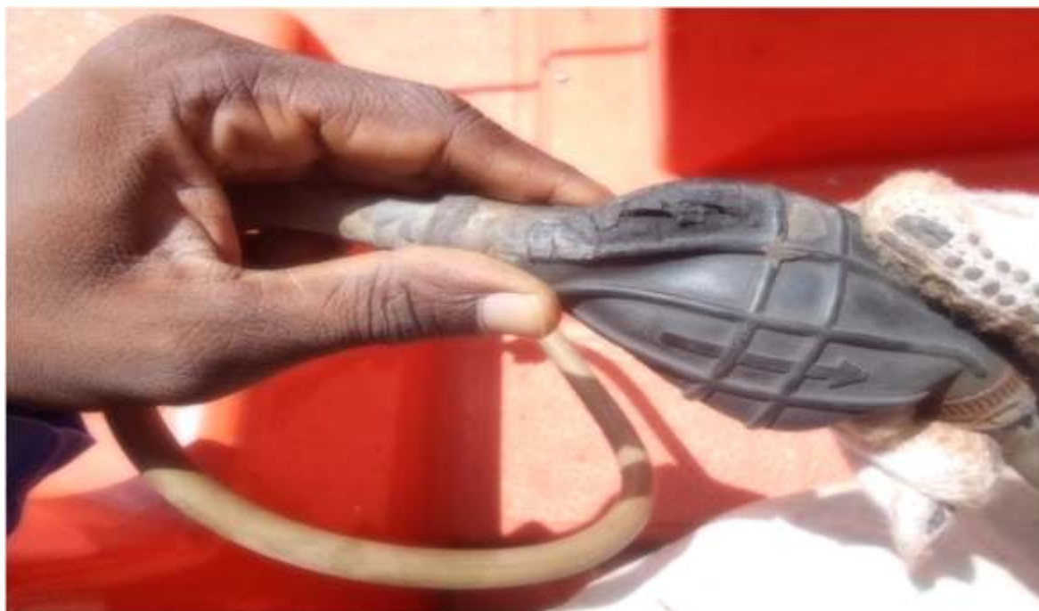
La pompe a main endommagée
