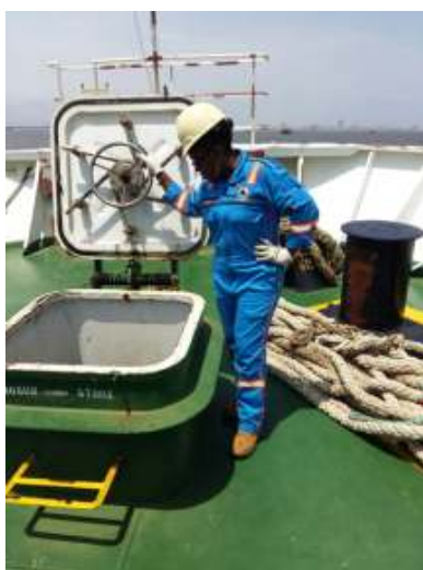
Officier de contrôle Féminin Inspecte le Hayon Blindé
