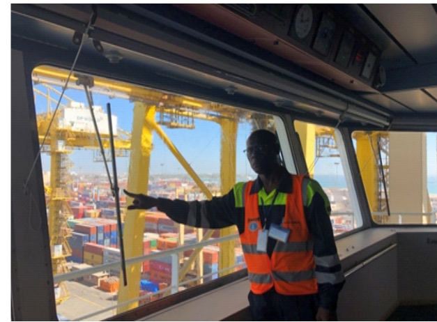
L'essuie-glace à la passerelle ne fonctionne pas
