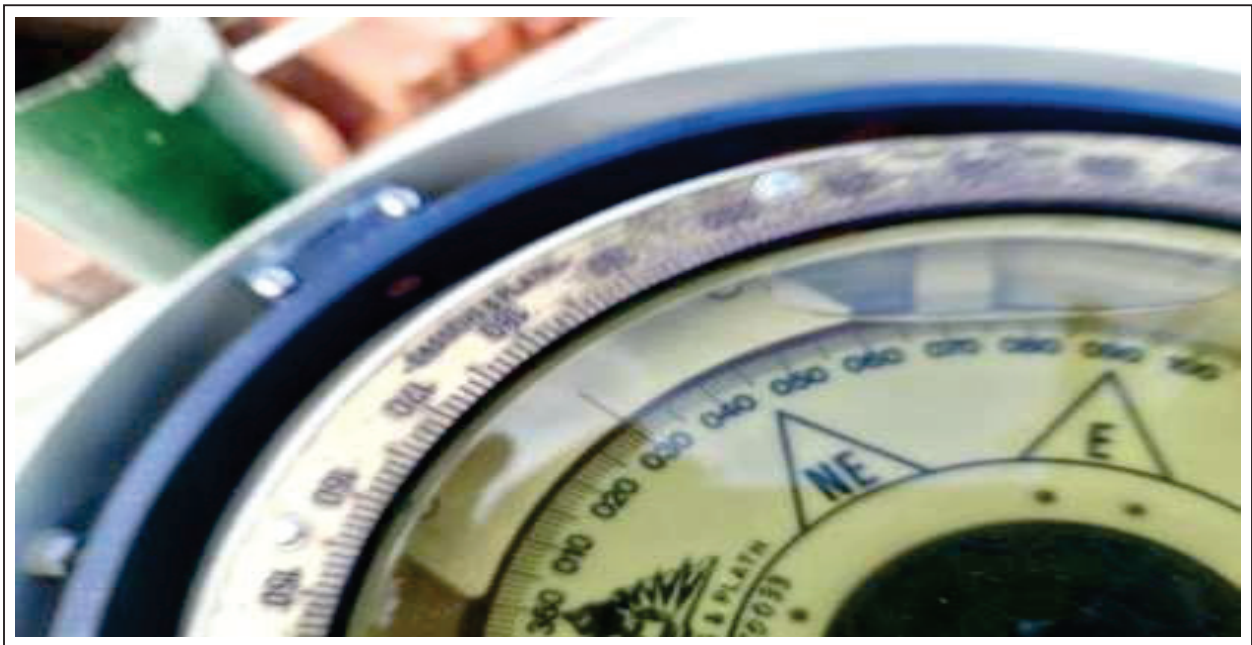
Magnetic compass containing bubbles Compas magnétique défectueux en raison de la présence de bulles dans la cuve
