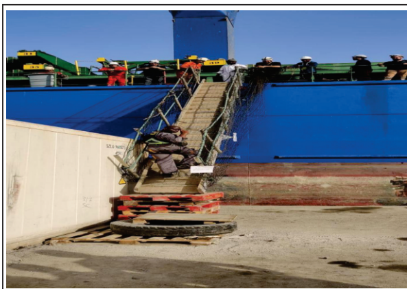
Dangerous and inappropriate Gangway La passerelle est jugée non conforme aux normes de sécurité et constitue un risque potentiel.
