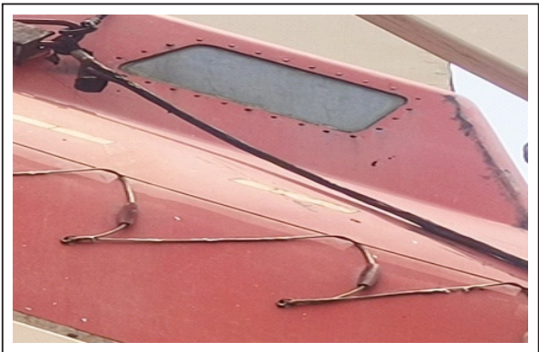
Free Fall Life Boat ropes painted over Cordages du canot de sauvetage à chute libre recouverts de peinture
